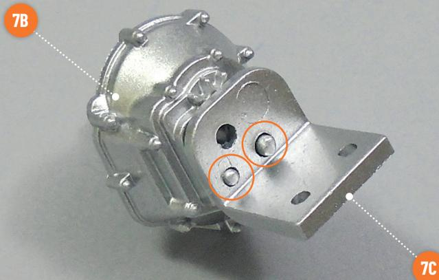
Stecken Sie die beiden Löcher der Halterung **7C** auf die entsprechenden Stifte des Lagerschildes **7B**. Richten Sie die Komponenten wie abgebildet aus: Aufgrund der Maße der Löcher und Stifte ist nur eine Montagerichtung möglich.
