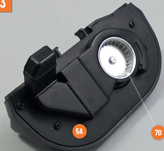
Nehmen Sie die Baugruppe des Gebläsekastens zur Hand und setzen Sie das Gebläserad **7D** in die entsprechende Öffnung. Richten Sie die Teile wie auf dem Foto gezeigt aus: Stecken Sie den Stift auf der Rückseite des Rads in das entsprechende Loch an der Rückwand **5A**, um zu verhindern, dass sich das Rad dreht.
