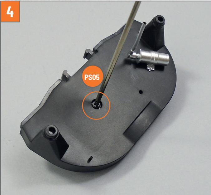
Drehen Sie die Baugruppe des Gebläsekastens um und befestigen Sie das Rad mit einer Schraube **PS05** im angezeigten Loch.
