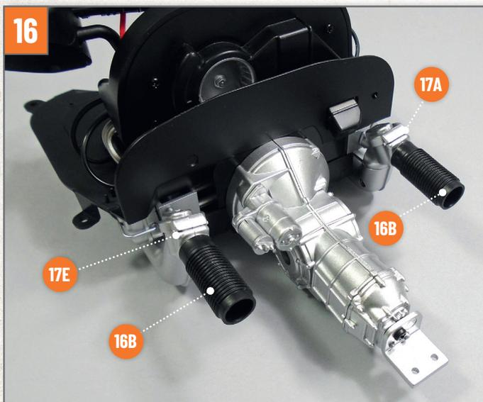
Nehmen Sie die beiden Warmluftschläuche **16B**, die Sie in Ausgabe 16 erhalten haben. Befestigen Sie die beiden Schläuche an den Vorderenden der Wärmetauscher **17A** und **17E** und richten Sie die Teile wie auf dem Foto gezeigt aus.
