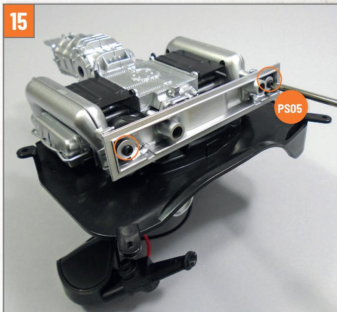
Befestigen Sie Teil 1 des Auspufftopfs mit zwei Schrauben **PS05** am Rest der Baugruppe.
