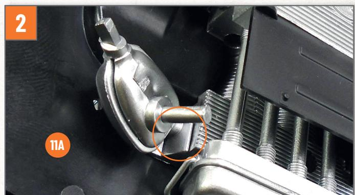
Nehmen Sie den Motor Ihres Modells zur Hand. Installieren Sie die linke Verbindung an der Unterseite des hinteren Motorabdeckblechs **11A**, wie mit dem Kreis auf dem Foto hervorgehoben.
