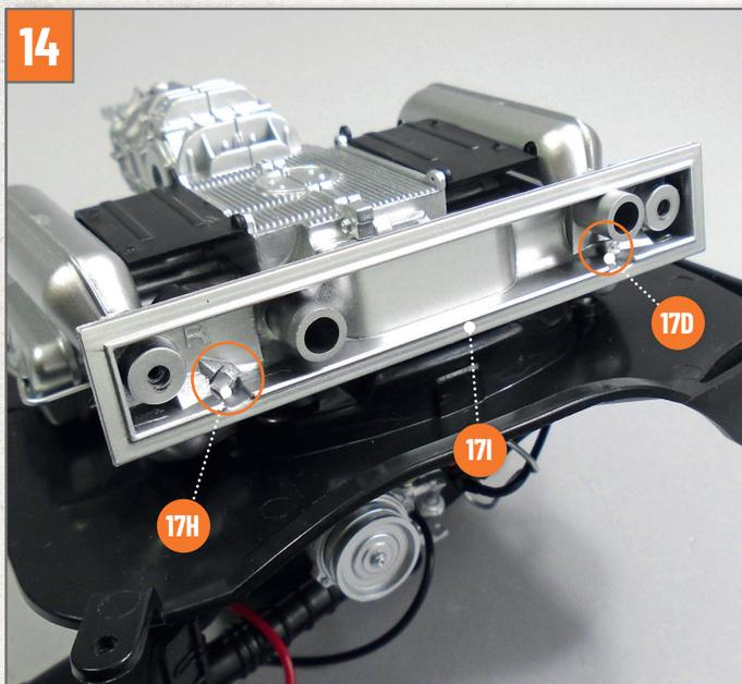
Überprüfen Sie, ob die Enden der Verbindungen **17D** und **17H** vollständig aus der Innenseite des Auspufftopfs **17I** herausragen.
