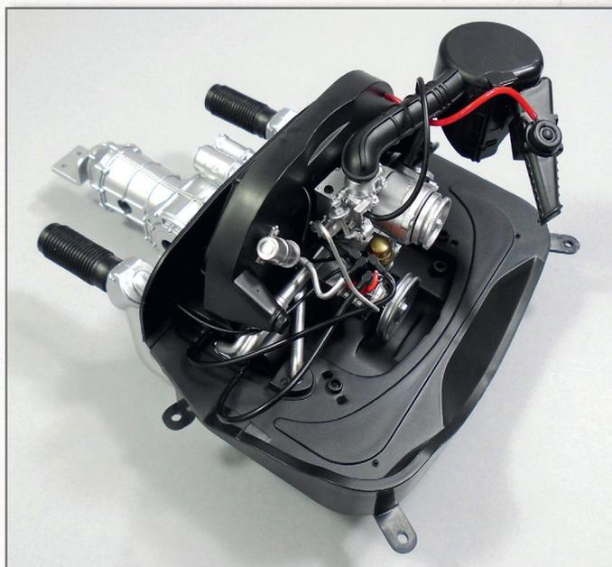
So sieht der Motor samt Anbauteilen, Verblechung und Getriebe nach dem Einbau der ersten Komponenten des Abgas- und Heizsystems aus.
