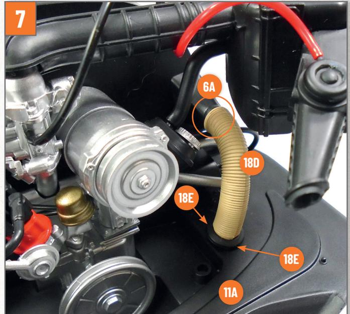
Installieren Sie ebenso den zweiten Heizschlauch **18D** auf der rechten Seite der Baugruppe. Stecken Sie sein freies Ende auf den entsprechenden Stift des Gebläsekastens **6A** und das andere Ende auf das Motorabdeckblech **11A**, indem Sie die Laschen der Schelle **18E** in die Öffnungen einführen.
