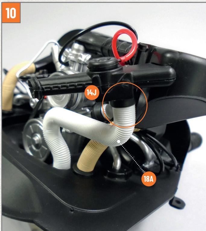
Stecken Sie das andere Ende des Luftfilterschlauchs **18A** auf den unteren Stift des Luftfilters **14J**.
