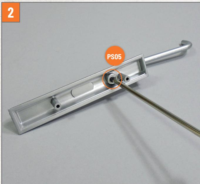
Befestigen Sie die Teile, indem Sie eine Schraube **PS05** im angezeigten Loch an der Innenseite des Auspufftopfs festziehen.
