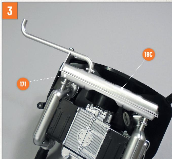
Nehmen Sie den Motor Ihres Modells zur Hand. Verbinden Sie Teil 2 des Auspufftopfs **18B** mit Teil 1 **171** und achten Sie dabei auf die korrekte Ausrichtung der Teile, so wie auf dem Foto gezeigt.
