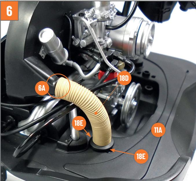
Stecken Sie das freie Ende eines Heizschlauchs **18D** auf den linken Stift des Gebläsekastens **6A**. Setzen Sie das andere Ende des Heizschlauchs auf die entsprechende Stelle am hinteren Motorabdeckblech **11A** und stecken Sie die Laschen der Schelle **18E** in die entsprechenden Öffnungen.
