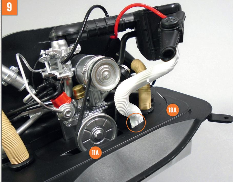
Setzen Sie das gebogene Ende des Luftfilterschlauchs **18A** auf den im Bild durch den Kreis hervorgehobenen Stift des hinteren Motorabdeckblechs.
