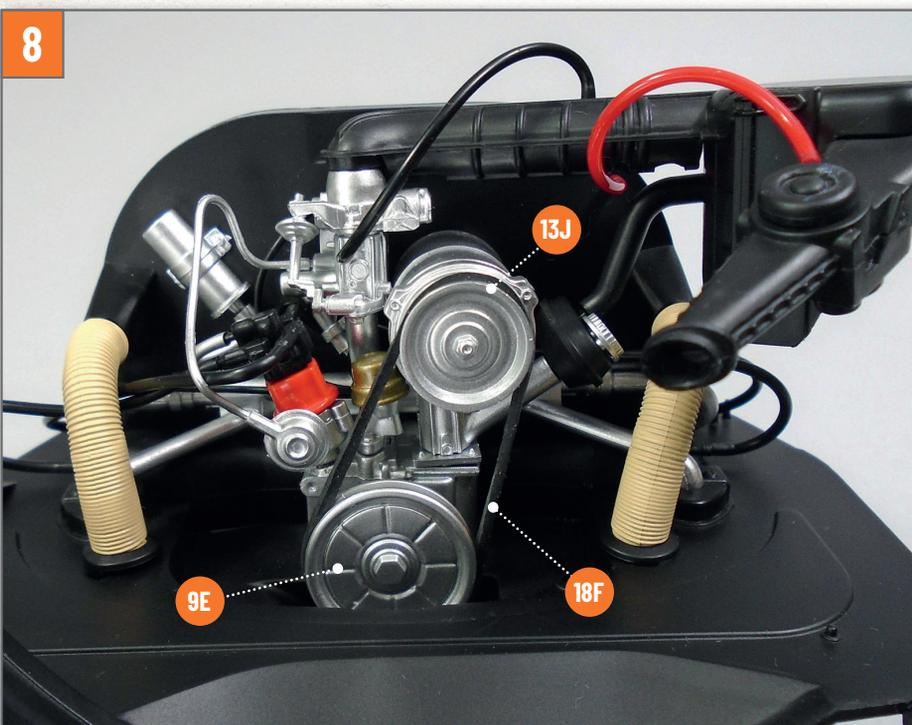
Platzieren Sie den Keilriemen **18F** wie auf dem Foto, um die Riemenscheibe **9E** und **13J** zu verbinden.
