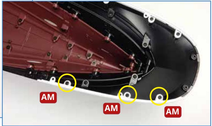
**2** Auf die gleiche Weise wird auf der gegenüberliegenden Seite die Backbord-Abschlussleiste **113B** mit drei Schrauben **AM** am Heckabschnitt **112A** befestigt.
