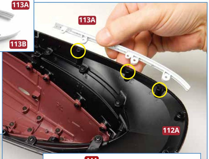
**1** Nehmen Sie die Steuerbord-Abschlussleiste **113A** und setzen Sie sie testweise auf die Steuerbordseite des Heckabschnitts **112A**. Stimmen Laschen und Aufnahmen überein (rechts und unten gelb eingekreist), fixieren Sie die Leiste mit drei Schrauben **AM** am Heckabschnitt.
