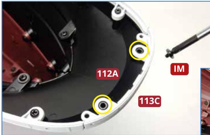
**3** Setzen Sie die Heck-Abschlussleiste **113C** mittig auf den Heckabschnitt **112A** und befestigen Sie ihn mit zwei Schrauben **IM**.
