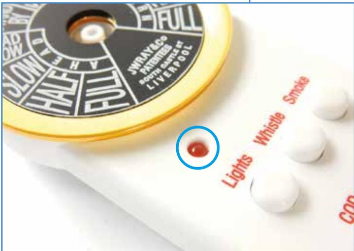
**2** Nehmen Sie die Platine **116F** und positionieren Sie sie im Vorderteil der Fernbedienung **115A**. Vergewissern Sie sich, dass die rote LED in der runden Aussparung sitzt (blau eingekreist) und dass das große Loch der Platine den Zapfen in der Mitte der Scheibe **115D** umschließt (gelb eingekreist). Ist die Platine perfekt ausgerichtet, befestigen Sie sie mit vier Schrauben **AP**. Ziehen Sie die Schrauben nicht zu fest an, da dies die Platine beschädigen könnte.
