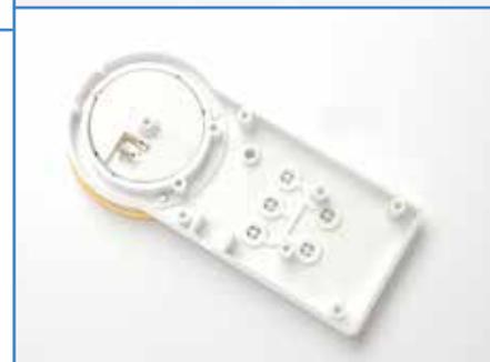
**1** Legen Sie das Vorderteil der Fernbedienung, das Sie mit der Ausgabe 115 zusammengebaut haben, und die Knöpfe **116E** bereit. Richten Sie das Vorderteil **115A** mit der Oberseite nach unten aus und setzen Sie von hinten die Knöpfe ein, wie es die Fotos rechts zeigen.
