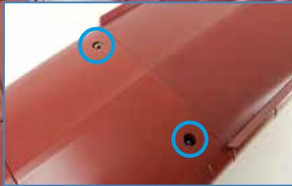
**2** Platzieren Sie die Platine **117A** so im Rumpf, dass ihre beiden Netzanschlüsse in den oben blau eingekreisten Löchern sitzen und die Löcher der Platine mit den Aufnahmen am Rumpf fluchten. Fixieren Sie die Platine mit sechs Schrauben **QM**.
