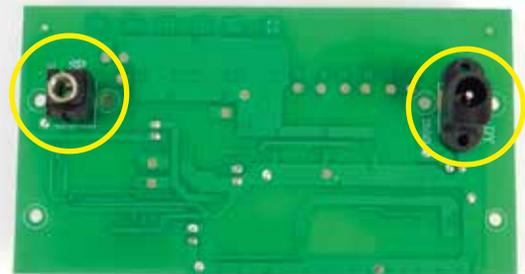
**1** Legen Sie die Hauptplatine **117A** bereit und sehen Sie sich genau an, wie sie im Rumpf ausgerichtet wird: Das Foto oben zeigt, in welche Richtung welche Kante weist. Auf der Unterseite der Platine befinden sich zwei Netzanschlüsse (oben rechts gelb eingekreist), diese gehören in die Löcher des Rumpfs, die im Foto rechts weiß eingekreist sind.
