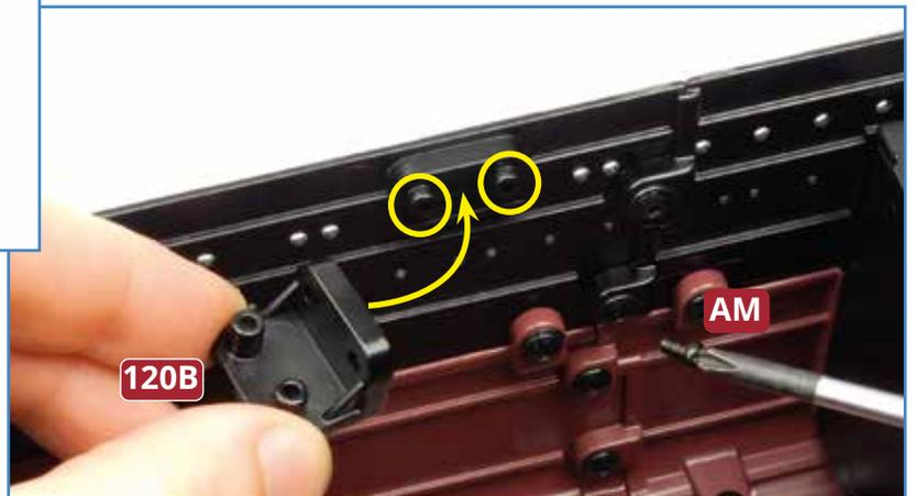
**1** Stellen Sie den Rumpf Ihres Modells auf Ihre Arbeitsplatte. Nehmen Sie die beiden Winkel **120B** und bringen Sie sie mit je zwei Schrauben **AM** unweit der Maschinenraumdecke **119A** am Rumpf an.
