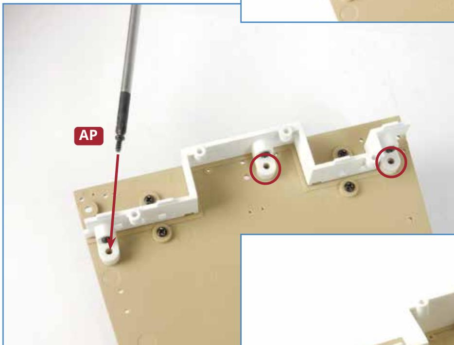
**2** Nehmen Sie das Poopdeck **124B** und drehen Sie es vorsichtig auf den Kopf. Setzen Sie die Rückwand **127A** entlang der kleinen Rippe auf der Unterseite des Poopdecks auf und befestigen Sie sie mit drei Schrauben **AP**.
