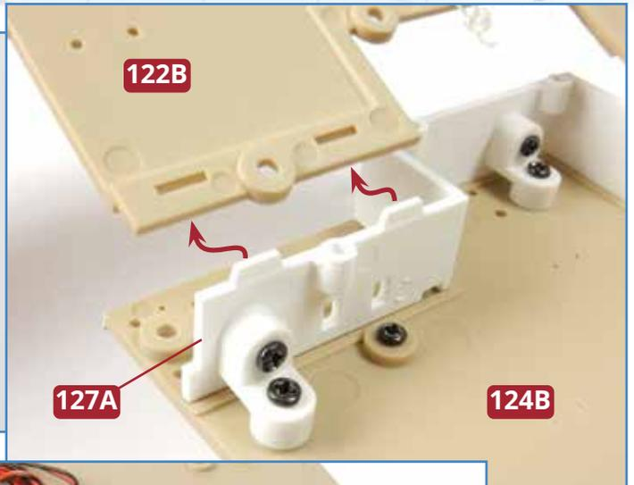
**3** Legen Sie das achtere C-Deck **122B** bereit. Führen Sie das Deck mit dem Poopdeck **124B** zusammen. Dabei müssen die Zapfen der Rückwand **127A** in die Schlitz des C-Decks eingefügt werden (rechts, gelb eingekreist). Fixieren Sie die Decks mit vier Schrauben **AP** aneinander (rechts, rot eingekreist).
