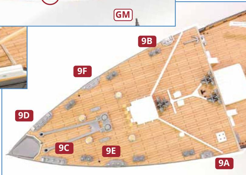
**6** Befestigen Sie das Vorderdeck mit sechs Schrauben **GM** (aus Ausgabe 9) an der Rumpfstruktur. Nehmen Sie die Klampen **9A, 9B, 9C, 9D, 9E** und **9F** (ebenfalls aus Ausgabe 9) zur Hand. Positionieren Sie sie über den Schrauben und fixieren Sie sie, sofern notwendig, mit Sekundenkleber.
