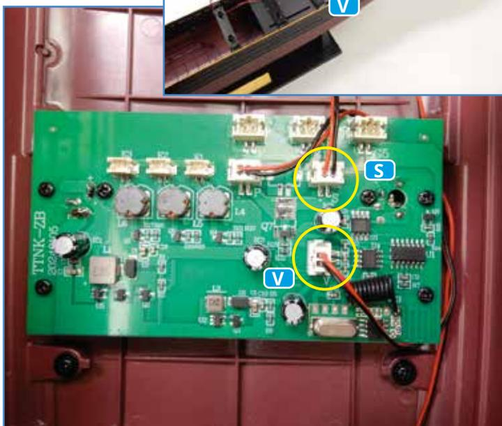
**10** Positionieren Sie die Baugruppe des Poopdecks und des achteren C-Decks auf der Rumpfstruktur. Führen Sie das LED-Kabel unter den Querver Verstärkungen hindurch im Rumpf nach vorne und verbinden Sie es mit dem Port **S** der Hauptplatine. Verfahren Sie genauso mit dem Motor-Kabel: Dessen Stecker wird am Port **V** der Hauptplatine angeschlossen.
