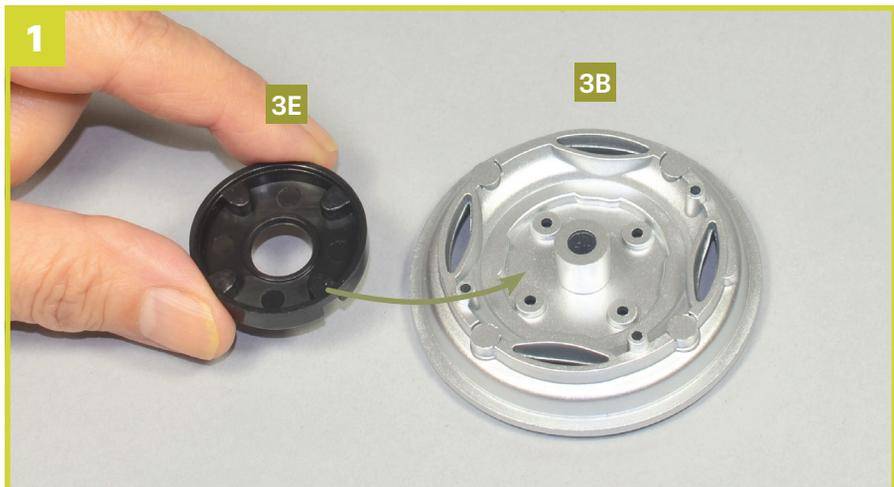
Setzen Sie die Bremstrommel **3E** wie durch den Pfeil angedeutet in die mittlere Öffnung der Außenfelge **3B**.
