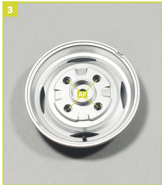
Drehen Sie die Außenfelge **3B** um, halten Sie die Bremstrommel **3E** in Position und fixieren Sie die Bauteile mit vier Schrauben **AP** miteinander. Drehen Sie dafür zunächst jede Schraube leicht ein und ziehen Sie sie anschließend fest.
