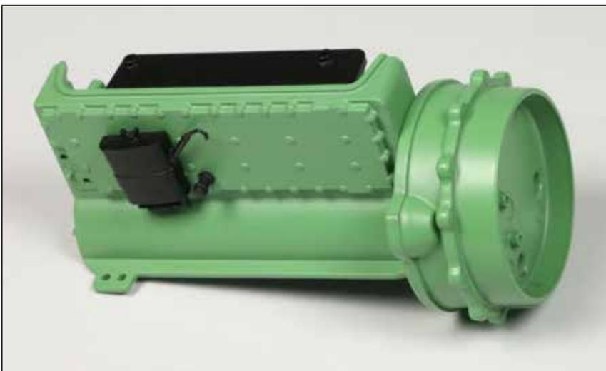
An der linken Motorhälfte wurden ein Befestigungsrahmen sowie der Lenkungsölbehälter und ein Verbinder angebracht. Das Kupplungsgehäuse wurde mit der Motorhälfte verschraubt.
