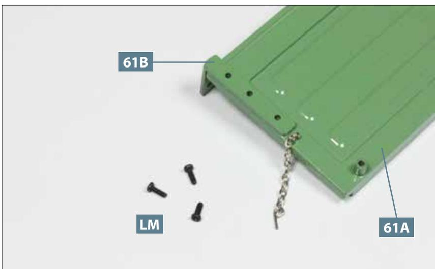
**02** Der Befestigungswinkel **61B** ist korrekt auf der Vorderwand **61A** platziert, wenn die Bohrungen bzw. Aufnahmen beider Teile fluchten, wie abgebildet. Legen Sie drei Schrauben **LM** bereit.
