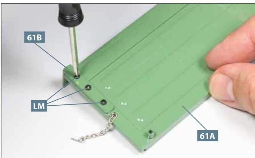
**03** Fixieren Sie den Befestigungswinkel **61B** mit den drei Schrauben **LM** an der Vorderwand **61A**.
