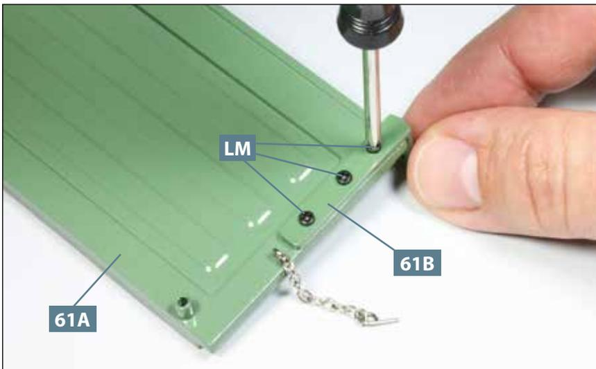
**05** Befestigen Sie den Befestigungswinkel **61B** mit den drei Schrauben **LM** an der Vorderwand **61A**.
