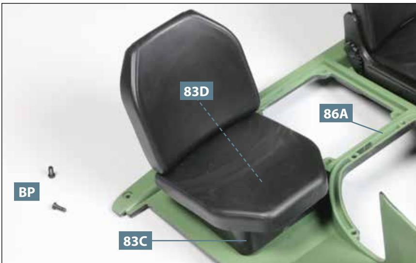
**05** Platzieren Sie das Sitzgestell **83C** des Beifahrersitzes auf der Werkzeugkiste **83D**. Halten Sie den Sitz in Position, drehen Sie die Baugruppe um und drehen Sie zwei Schrauben **BP** in die Bohrungen bzw. Aufnahmen von Kabinenboden **86A**, Werkzeugkiste **83D** und Sitzgestell **83C**.
