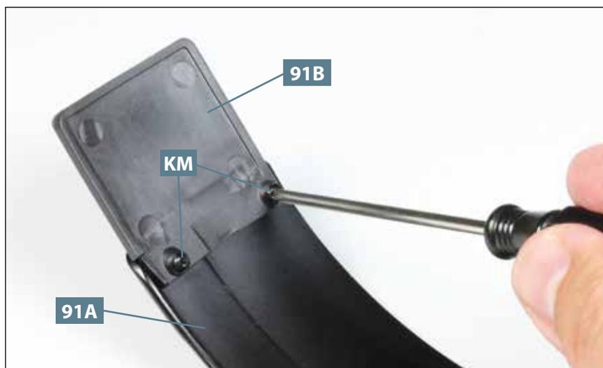
**03** Befestigen Sie den Kotschutz **91B** mit den zwei Schrauben **KM** am Vorderradkotflügel **91A**, wie abgebildet.
