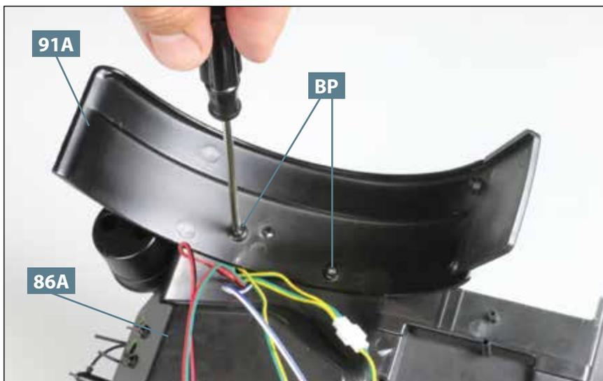
**05** Fixieren Sie den Vorderradkotflügel **91A** am Kabinenboden **86A**, indem Sie in den Bohrungen beider Teile zwei Schrauben **BP** eindrehen, wie abgebildet.
