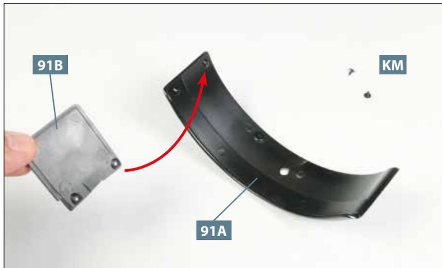
**01** Legen Sie zwei Schrauben **KM** und den linken Vorderradkotflügel **91A** auf Ihre Arbeitsplatte. Nehmen Sie den linken Kotschutz **91B** und führen Sie dessen Bohrungen zu den Aufnahmen am hinteren Ende des Kotflügels, wie angedeutet.
