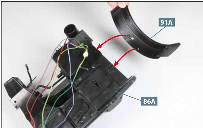
**04** Stellen Sie die Kabinenboden-Baugruppe **86A** kopfüber auf Ihre Arbeitsplatte. Führen Sie den linken Vorderradkotflügel **91A** zu den beiden Aufnahmen, die sich links an der Unterseite des Kabinenbodens befinden, wie es die beiden Pfeile andeuten.
