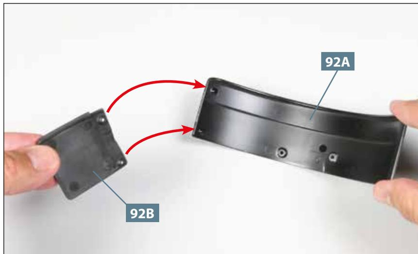
**01** Nehmen Sie den rechten Kotschutz **92B** und führen Sie dessen Bohrungen zu den Aufnahmen am hinteren Ende des rechten Kotflügels **92A**, wie angedeutet.
