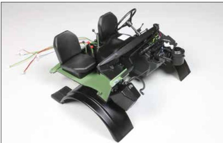
Der rechte Vorderradkotflügel ist mit einem Kotschutz versehen und am Kabinenboden befestigt.
