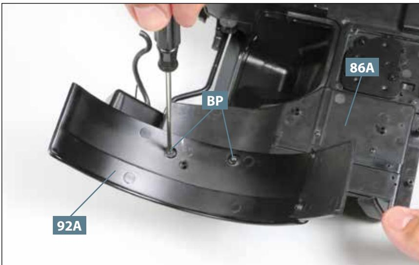
**05** Fixieren Sie den Vorderradkotflügel **92A** am Kabinenboden **86A**, indem Sie in den Bohrungen beider Teile zwei Schrauben **BP** eindrehen, wie abgebildet.
