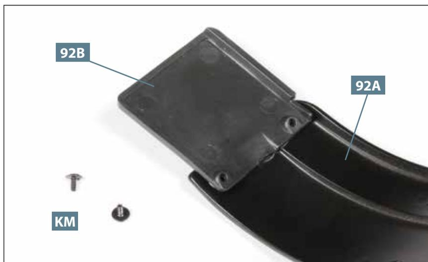
**02** Der Kotschutz **92B** ist korrekt am Vorderradkotflügel **92A** aufgesetzt. Legen Sie zwei Schrauben **KM** bereit.
