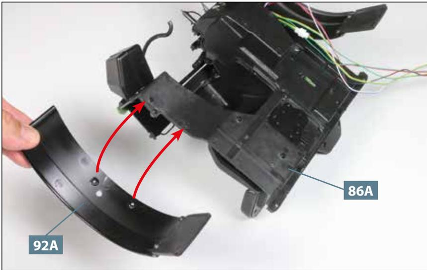
**04** Stellen Sie die Kabinenboden-Baugruppe **86A** kopfüber auf Ihre Arbeitsplatte. Führen Sie den rechten Vorderradkotflügel **92A** zu den beiden Aufnahmen, die sich rechts an der Unterseite des Kabinenbodens befinden, wie es die beiden Pfeile andeuten.
