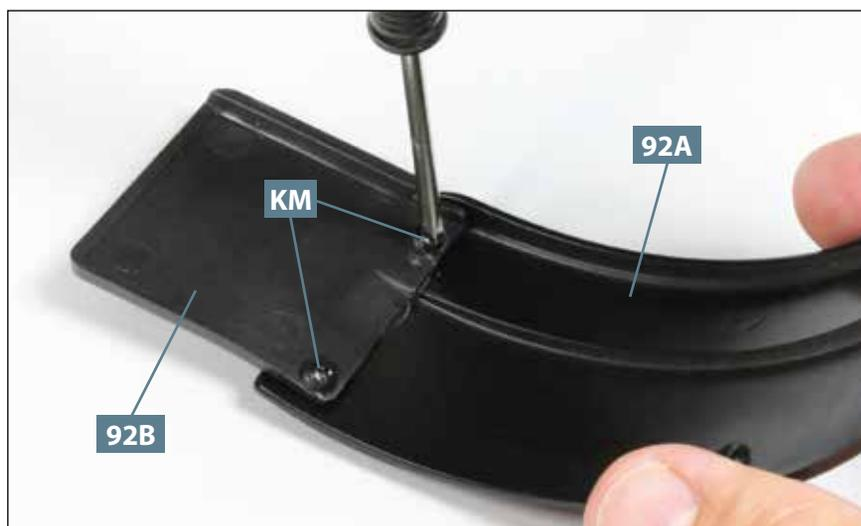
**03** Befestigen Sie den Kotschutz **92B** mit den zwei Schrauben **KM** am Vorderradkotflügel **92A**, wie abgebildet.
