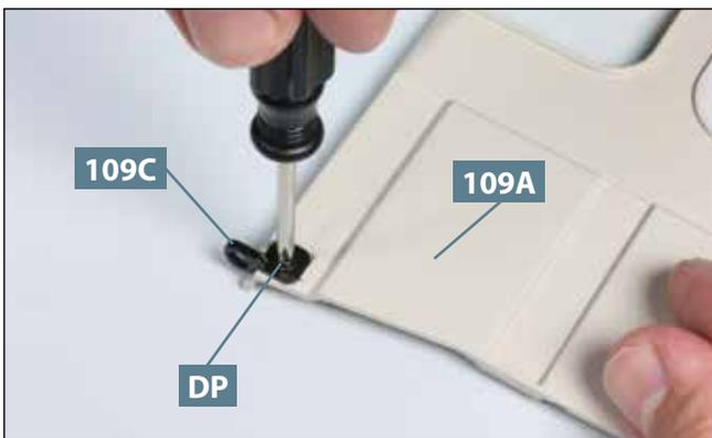
**03** Fixieren Sie die linke Halterung **109C** mit einer der Schrauben **DP** an der Fahrerhausverkleidung **109A**.
