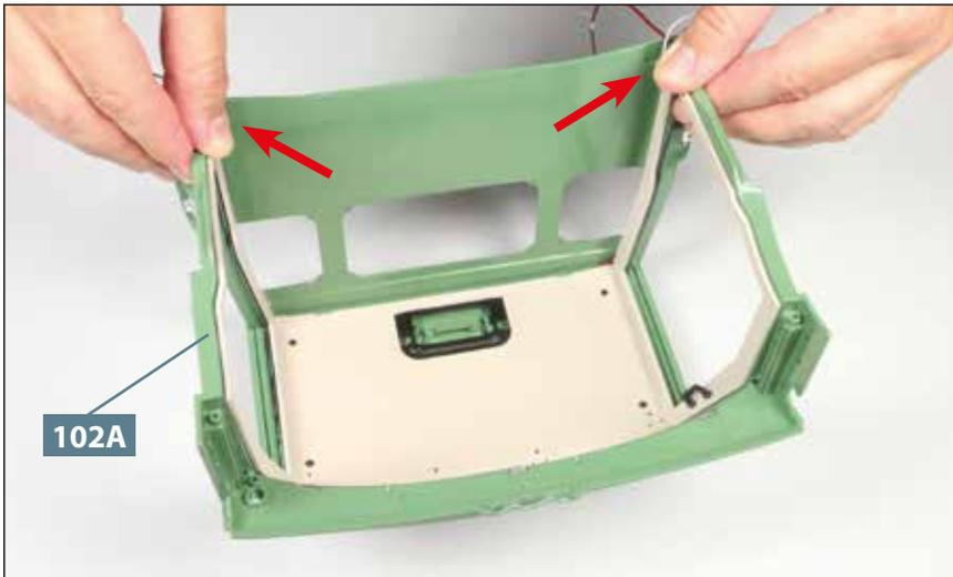
**07** Stellen Sie das Fahrerhaus **102A** auf Ihre Arbeitsplatte. Stellen Sie sicher, dass die gesamte Rückwand des Fahrerhauses freiliegt und alle Kabel sich in den seitlichen Hohlräumen befinden: Die Pfeile weisen auf diese Stellen.
