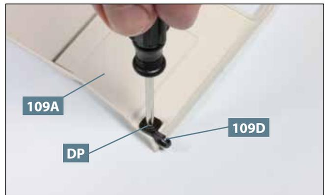
**04** Am rechten unteren Ende der Fahrerhausverkleidung **109A** wird die rechte Halterung **109D** mit der anderen Schraube **DP** befestigt, wie abgebildet.
