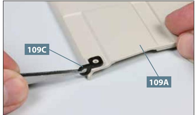
**02** Nehmen Sie die linke Halterung **109C** und positionieren Sie deren eckiges Ende in der Aufnahme am linken unteren Ende der Fahrerhausverkleidung **109A**.
