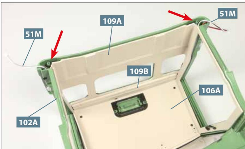
**08** Setzen Sie die hintere Fahrerhausverkleidung **109A** so in das Fahrerhaus **102A** ein, dass die beiden Zapfen der Verkleidungsleiste **109B** in den Aussparungen der Dachverkleidung **106A** sitzen. Gut zu erkennen ist, dass die Kabel **51M** in den Hohlräumen zwischen den Verkleidungsteilen und dem Fahrerhaus verlaufen. Die beiden schwarzen Halterungen der Verkleidung umfassen die grünen Schraubenaufnahmen des Fahrerhauses (Pfeile).
