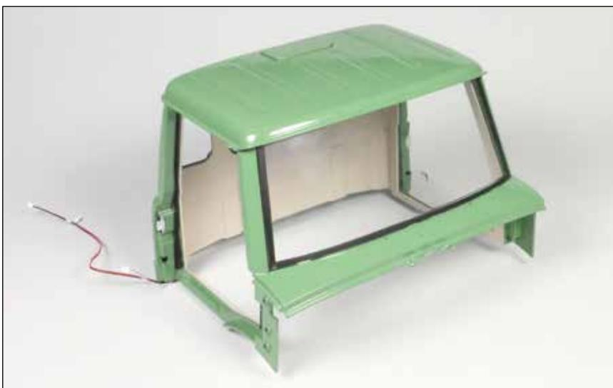
Die hintere Fahrerhausverkleidung wurde mit zwei Halterungen und einer Leiste versehen. Die Baugruppe ist in das Fahrerhaus eingefügt.
