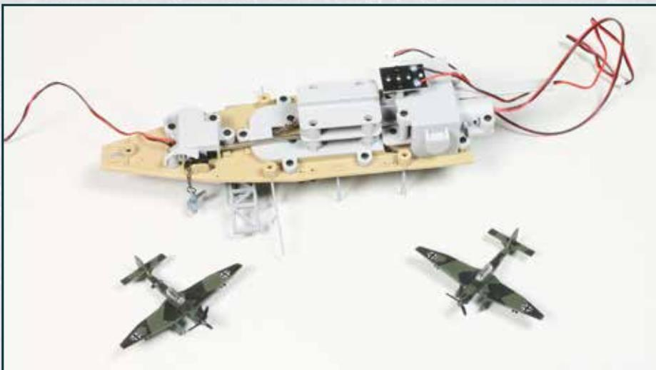
Das dritte Bordflugzeug ist mit Fahrwerksbeinen und Bomben ausgestattet. Das zweite Bordflugzeug hat einen Austauschpropeller erhalten. Am Motorgehäuse des Ankergetriebes ist eine Platine mit Endschalter befestigt.
